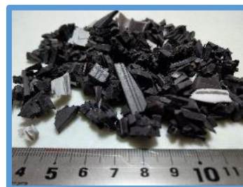
写真－3: フェライト磁石の破砕品
