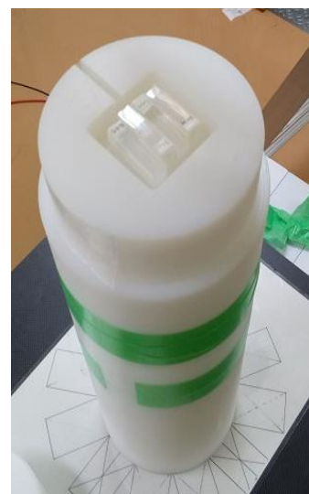
図 1 実験に使用したポリエチレンモデレータ(内部にゲル線量計:照射前に配置。この配置を PE 厚 0mm とする)
