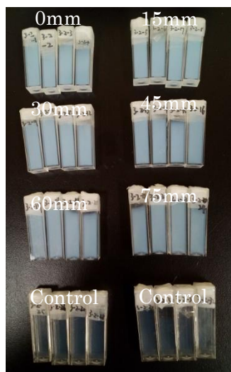
図 2 照射後のゲル線量計の白濁変化(数字は PE 厚を表す。下の 8 個はコントロール用の未照射ゲル)
