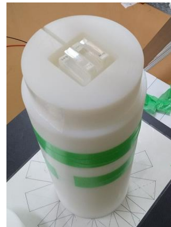
図1 実験に使用したポリエチレンモデレーター(内部にゲル線量計:照射前を配置。この配置をPE厚0mmとする)
