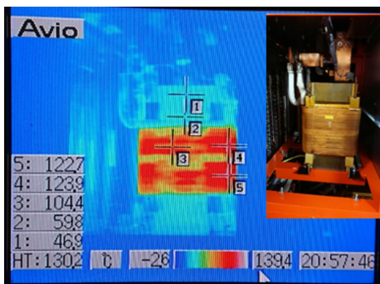
写真 1. CM1 電源チョークコイル温度測定 整して使用している。
