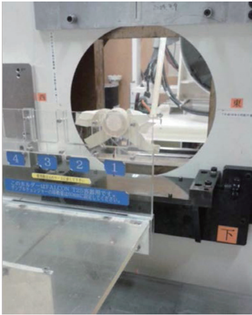
図2 器官培養切片を水平ビームにて照射した際の セッティングの写真
