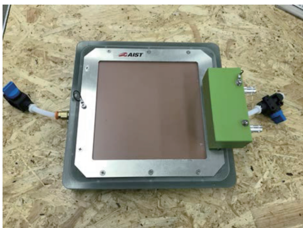
図 2. 改良した密封型・軽量ガスチャンバー
