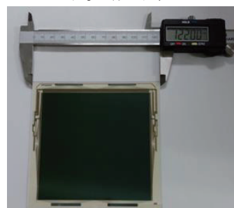
図 1 ガラス上に製膜したセンサアレイ
