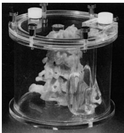
図 3 甲状腺を模擬した物理ファントム
