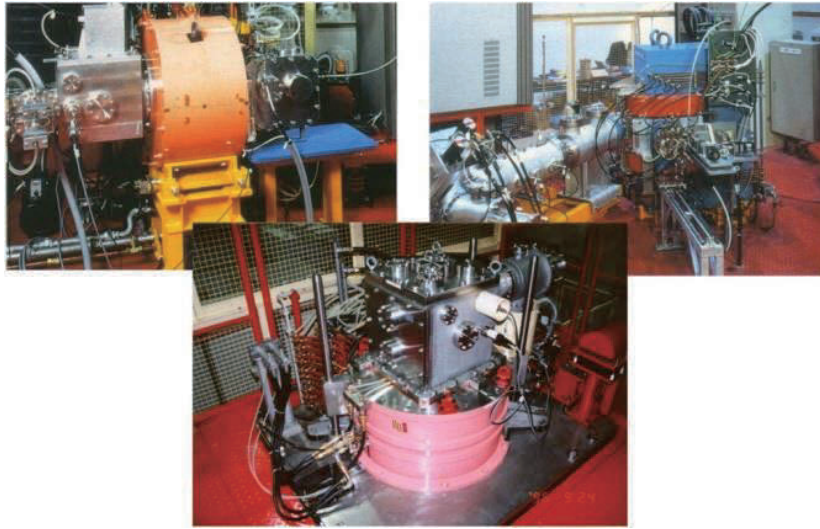
図 1.4 HIMAC のイオン源。左から NIRS-ECR、NIRC-HEC、PIG イオン源。
