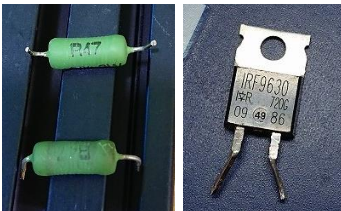
図 2. (左)赤熱していたホーロー抵抗 (右)端子間が短絡状態だった MOSFET の一つ
