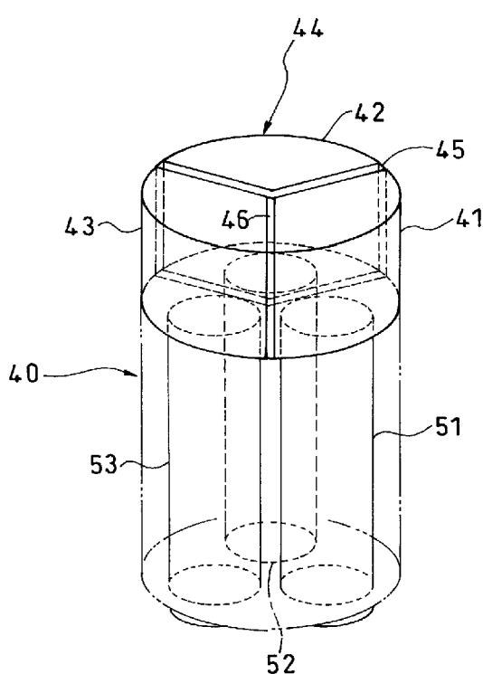
タの影になって間接的に入射する放射線の割合の組合せが、周方向における入射方向により異なるようにして、検出器の軽量化、放射線の検出効率の向上、半周又は全周方向の計測による検出情報の精緻化、設定の簡易化による操作性の向上を図る。
