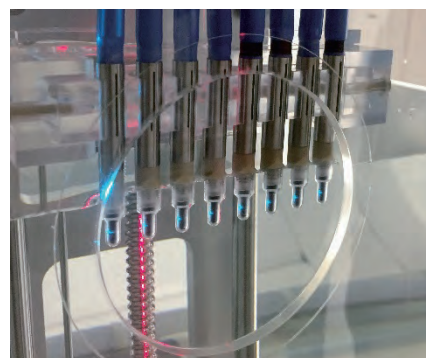
図4: 治療照射や品質保証のために開発した治具及び設置した線量計
