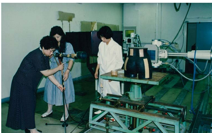
X線棟での実習風景 X線棟第一照射室において、患者に見立てたファントムからの散乱線の測定を行っていました。
