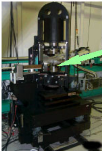
放射光を用いた高温高圧下 X線回折実験装置概念図
