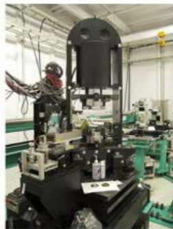
水素化物の形成過程の観測に使用された放射光X線回折装置
