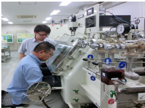
図1 ナトリウム取扱研修施設にあるグローブボックス内でのナトリウムサンプル作成作業の様子。グローブボックス内は大気中のごわずかな水分も除去されているために、高純度のナトリウム試料の作成が可能です。
