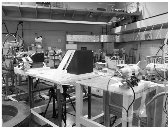
図1.実験のセットアップ。ビームは右下から左上に流れる。中央の黒いものが \text{B}_4\text{C} を添加した放射線遮蔽試料。
