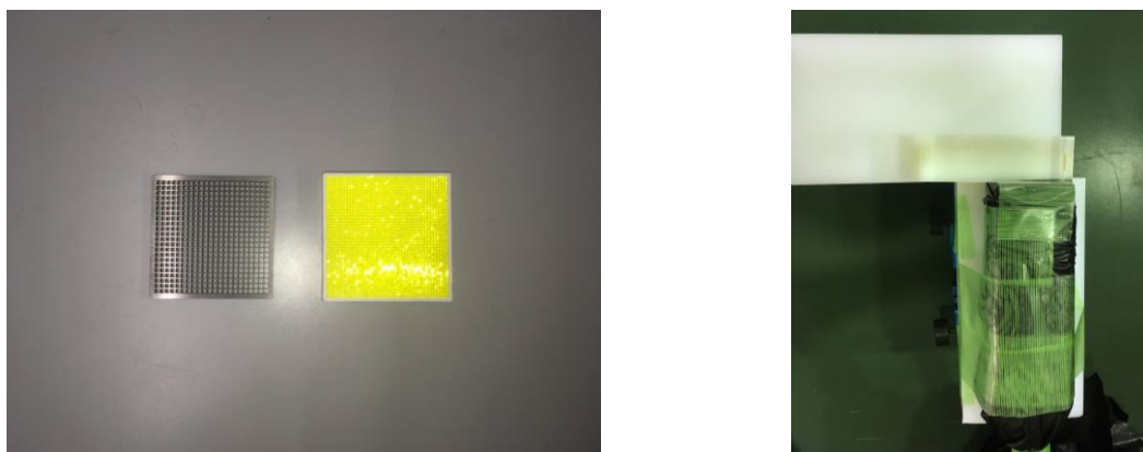
図 5: (左) 制動放射イメージング実験で使った、マルチホールコリメータと Ce:GAGG シンチレータアレイ (右) 照射時のセットアップの様子。PMT およびセンサをファントムに密着する
