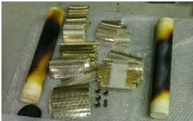
図 3. 取り外した絶縁支柱とコンタクト
