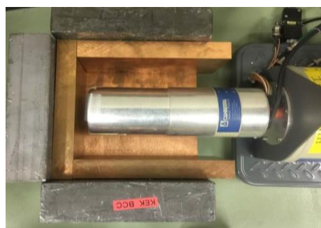
図 15：C8 コースでのセットアップの様子。(左) Ce:GAGG への照射セッティング。(右)H-Ge 検出器による Ce:GAGG の放射化測定。
