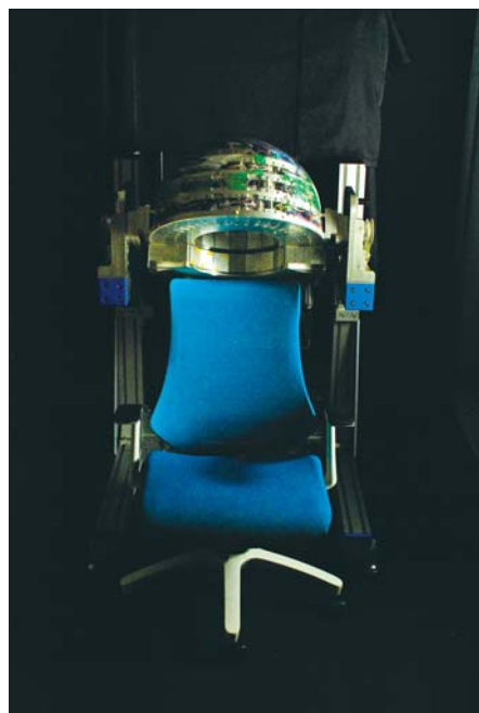
図4 開発したヘルメット型PET実証機
