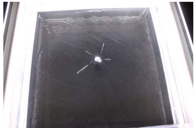
図5 大型霧箱を用いた放射線可視化のデモンストレーション ユーロセレン石から放出されるアルファ線の軌跡が可視化されている。
