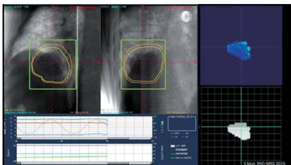
図10 X線腫瘍追跡装置の画面 左上が腫瘍の追跡画面、右上がスキャニング照射画面。この装置が腫瘍位置を判断して、照射のON/OFFを制御している。
