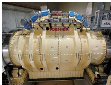
図11 重粒子線回転ガントリー装置の模式図(上)と治療室写真(中央)、回転ガントリー回転体(下)
