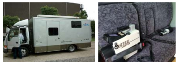
図2 モニタリングカー(左)とモニタリングカーに搭載したゲルマニウム半導体スペクトロメータ(右)
