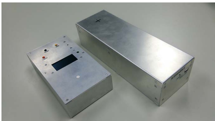
図 1 AD-1(左)とAD-2(右)の外観。AD-1では本体に制御用のスイッチやスペクトル標示用ディスプレイがついているが、AD-2では、USB 接続によって PC からの制御やモニタリングを行っている。
