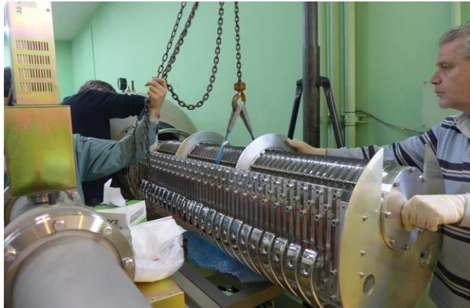
図. タンデトロン加速器本体タンクより加速管カラムを引き抜いて作業を行っている様子
