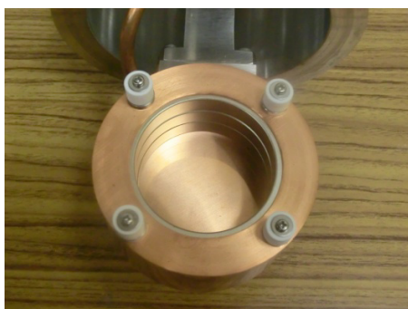
図 6. 永久磁石サプレッサを用いたファラデーカップ
