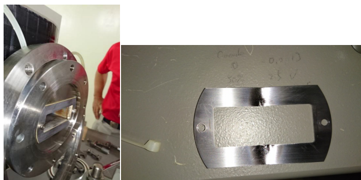
図6. 新規に製作したチェンバー（左）とビーム入り口保護用の厚さ 0.5mm タンタル板（右）
