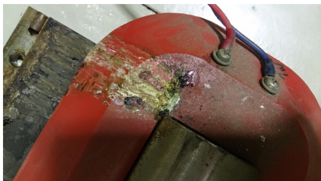
写真 1：Q-magnet コイル漏水部
