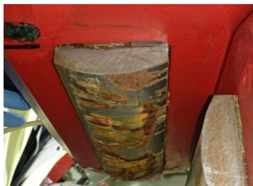
写真 2：漏水した Q-magnet の磁極面
