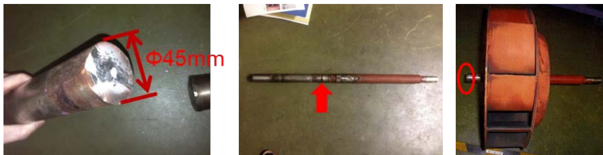
図 1. 破断した空調機のシャフト
