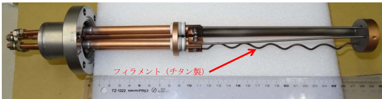
図 2. 抵抗加熱の金属蒸発源。真空内のフィラメントに電流を流し加熱して蒸発させる。
