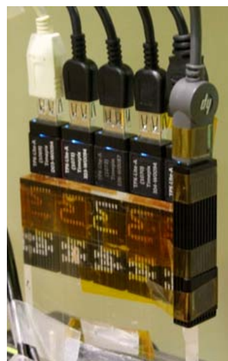
図 1 ピクセル型検出器 Timepix の HIMAC での校正実験時の写真
