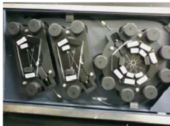
図6 FACS Aria に搭載されているFilter。左から、Violet、Red、Blue レーザーが入射される。表1 から、A)は488nm 半導体レーザーの585/42 フィルタ、B) C) D)は407nm 半導体レーザーの450/40フィルタ(Violet1)で観察する。
