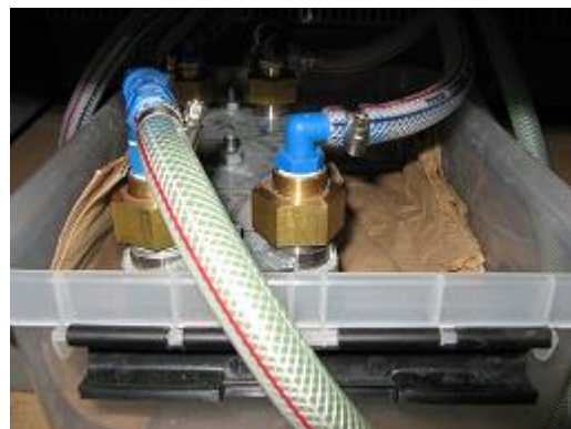
図9. 冷却水循環装置の熱交換器
