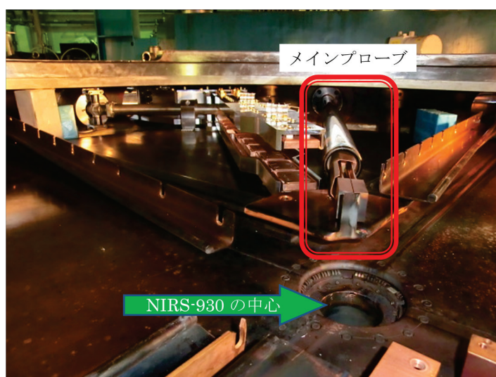
図5. サイクロトン内部から見たメインプローブ
