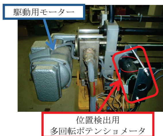
図 7. 駆動部位置検出用多回転ポテンショメータ
