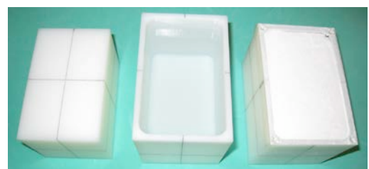
図 2：C6 コースにおける BOLPs の設置（左）と照射ターゲット：左からポリエチレン、水、酸化カルシウム（右）の写真。
