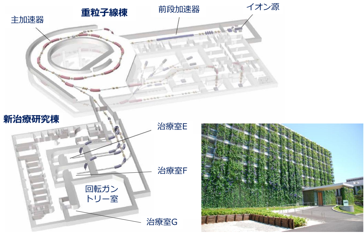
図 1：重粒子線棟と新治療研究棟。右写真は新治療研究棟正面玄関。
