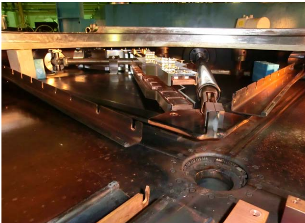
写真1. NIRS-930 内に設置された位相プローブ
