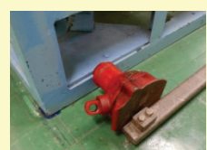
ジャッキによる位置の微調整
