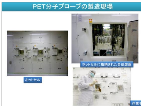
これは FDG という PET 分子プローブの合成装置の写真です。このような装置を使って毎日、人の手によらず、人が被ばくしないように遠隔的に薬を作っています。
