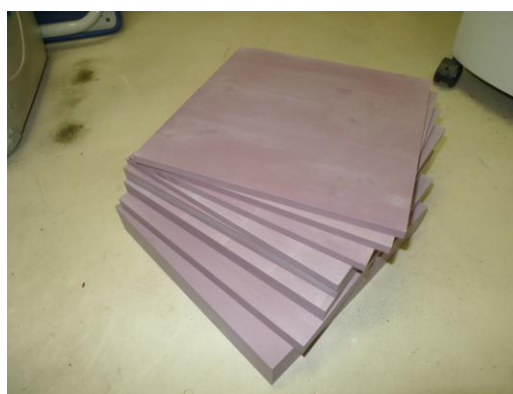
写真 1.板状フラットマッスルファントム
