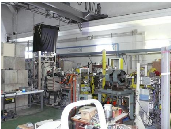
図 7. マイクロビーム専用照射ビームライン。細胞を照射する XY ステージはマイクロメーターを手動で操作していたが、いろいろな制限が大きいため 2009 年に電動化した。電動化後の XY ステージは図 9 に示した。
