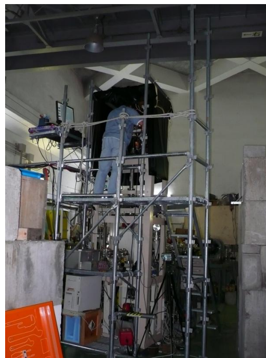
図 8. マイクロビーム細胞照射垂直ビームライン。顕微鏡の調整を行っている様子。
