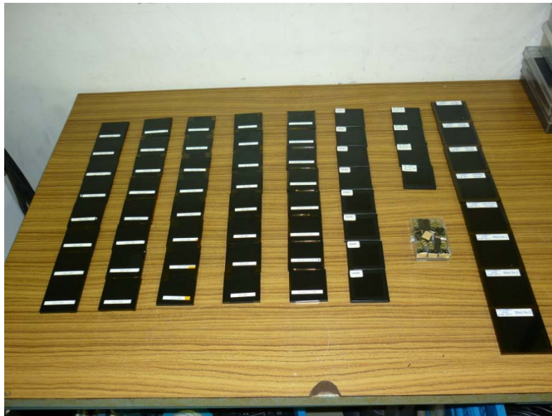
図 2 照射を行った線量計ホルダー。
