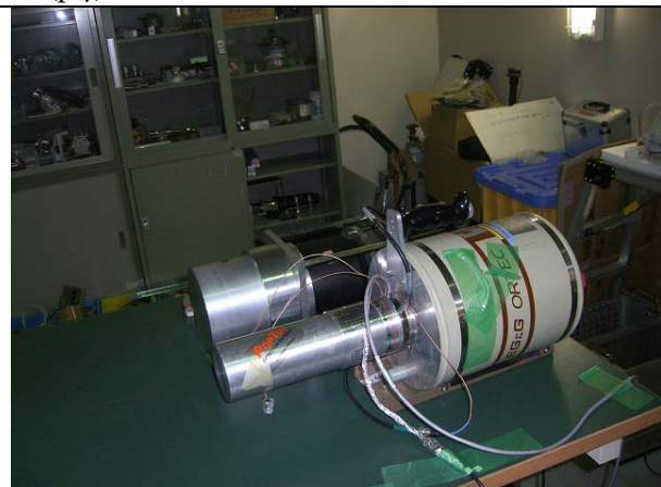
ガンマ線計測に利用したゲルマニウム半導体検出器と有機液体シンチレーター（127 mm in diam. 127 mm in length）
