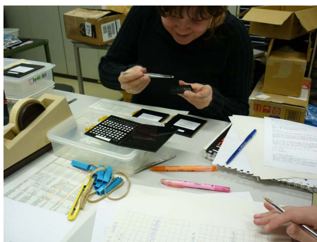
図3. 放医研が用意した照射用ホルダーに線量計を詰めているところ。
