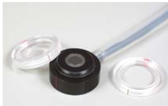
図2 標準線量計として使用している Markus 型線量計(PTW 社製 Type23343)
