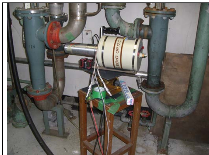
地下での放射化冷却水計測の写真 (計測ポイント)
