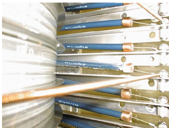
図 1. 加速管(左)と抵抗(奥) 加速管の電極プレートと直列に接続されている
