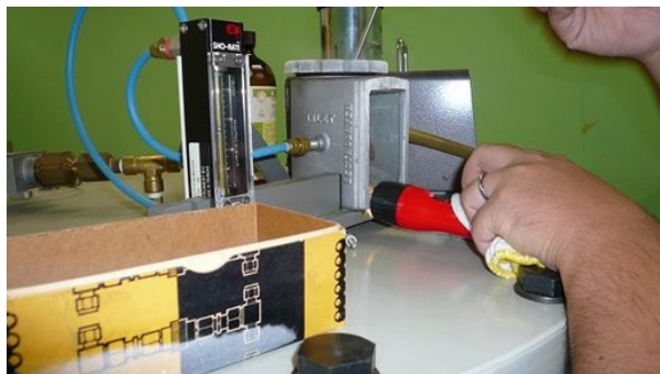
図 14. 露点計の窓の結露を見て露点を測定
