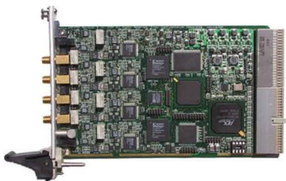
図 1 データ収集に使用する PXI の MCA モジュールである DXP-XMAP。
