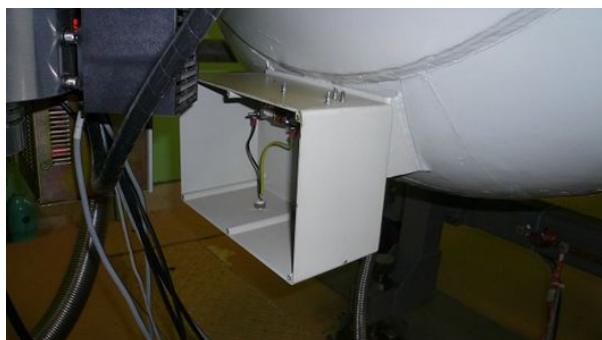
図 3. カラムカレントを測るための抵抗ボックス。 LE と HE 側にそれぞれある。
