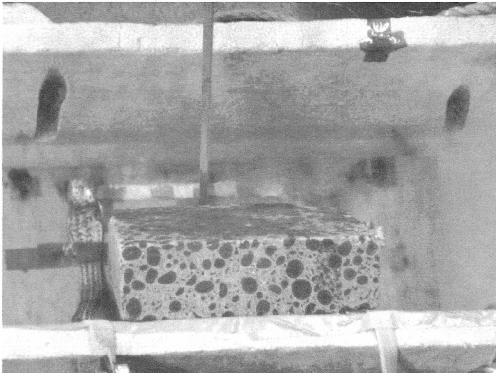
図 2. Ic 測定状況 (中央の灰白色のテープが CVD-YBCO 線材。タップ取付用のカプトンテープが 3 cm おきに貼り付けられている。右側から超電導から常電導に遷移しており液体窒素が蒸発している。コンクリートブロックは浮き上がり防止)
