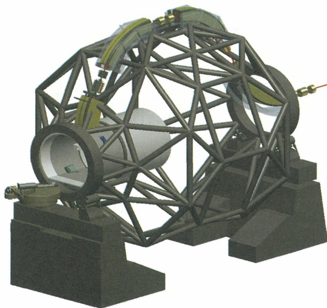
図 9. 炭素線回転ガントリーの概念設計。
