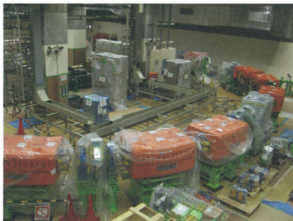
図 6．新施設に設置中のシンクロトロン
