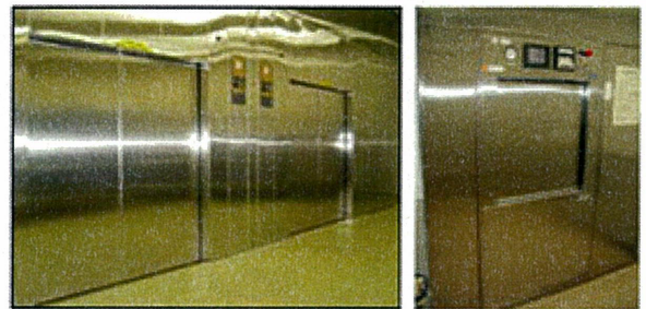
図1-1 左：高圧蒸気滅菌器 右：E0ガス滅菌器
