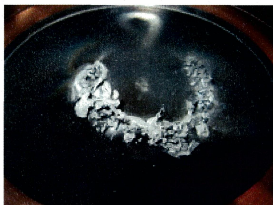
図 3. Be (厚さ 3 mm) のみターゲット破損状況 亀裂が入り冷却水が真空中に放出された。
