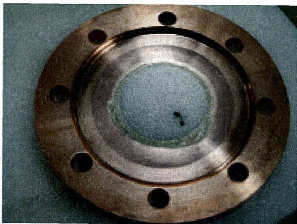
図 7. 実験用 Be(厚さ 0.2 mm)・Cu(厚さ 3 mm)。
