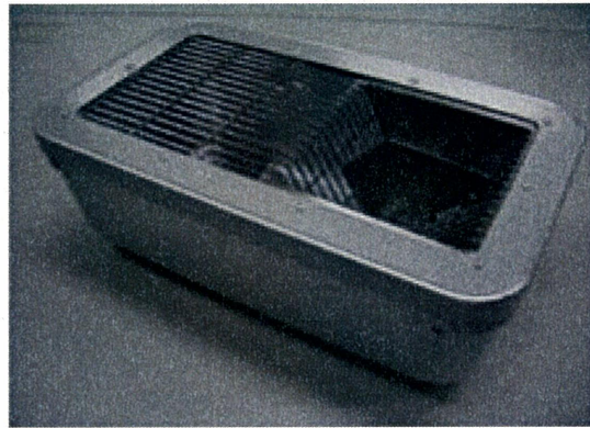
図4-1 トキワ製 マウス5匹用TM-413B ケージ：アルミニウム 170W×300D×110H フタ：アルミ打抜きステンレス金網張り
