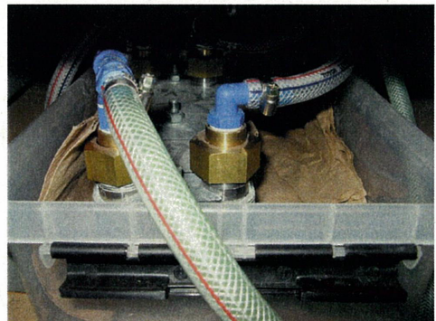
図6 交換した金属コネクタ。
