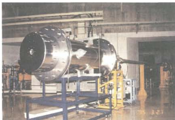
図3 HIMAC 物理汎用照射室に搬入された高エネルギー重イオン測定器
