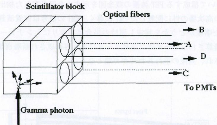
Fig.2 MRI 中で測定可能な PET 装置用検出器の概念図
