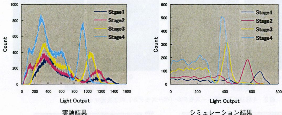
図5 次世代PET用検出器のエネルギースペクトル
