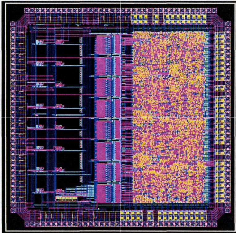
図 5 プリアンプから AD 変換器までを内蔵した、フロントエンド ASIC チップのレイアウト
