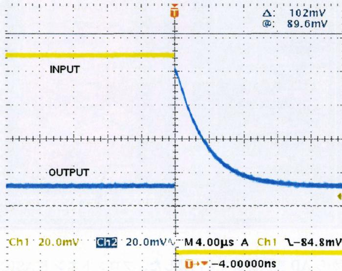
図 3 プリアンプのステップ応答
