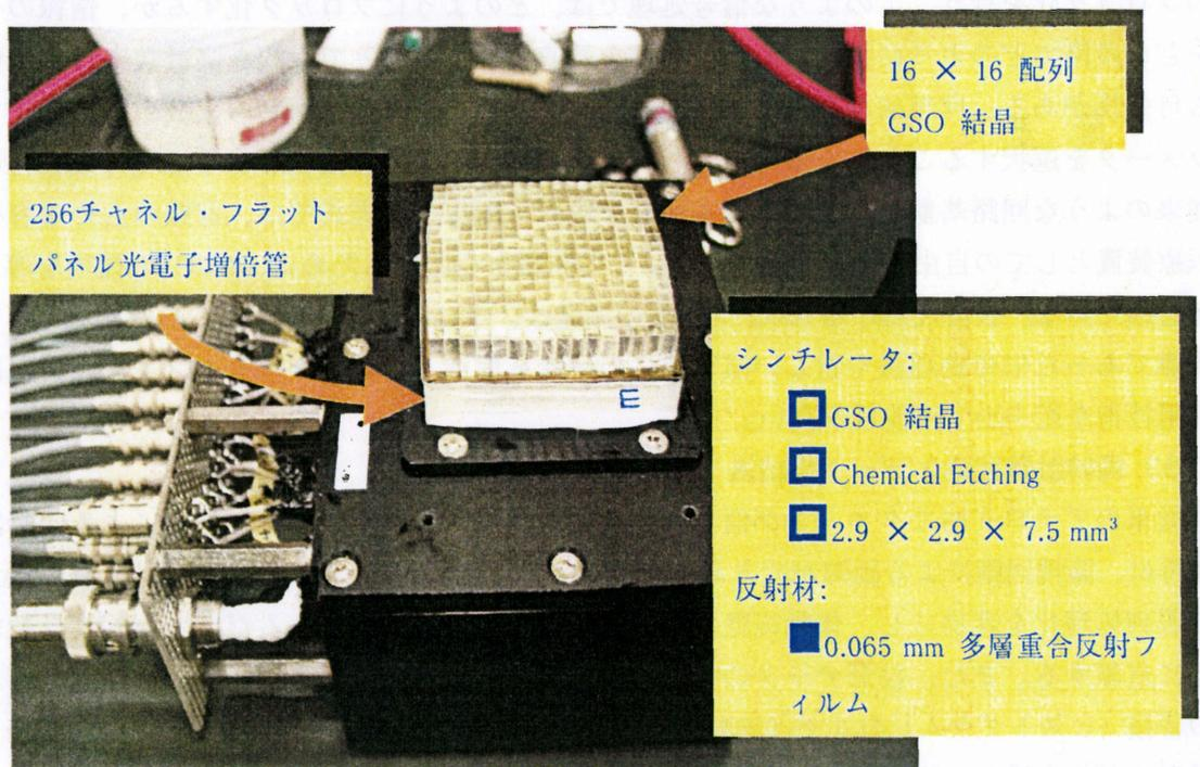
図2 256個の GSO 結晶素子と 256ch フラットパネル光電子増倍管
