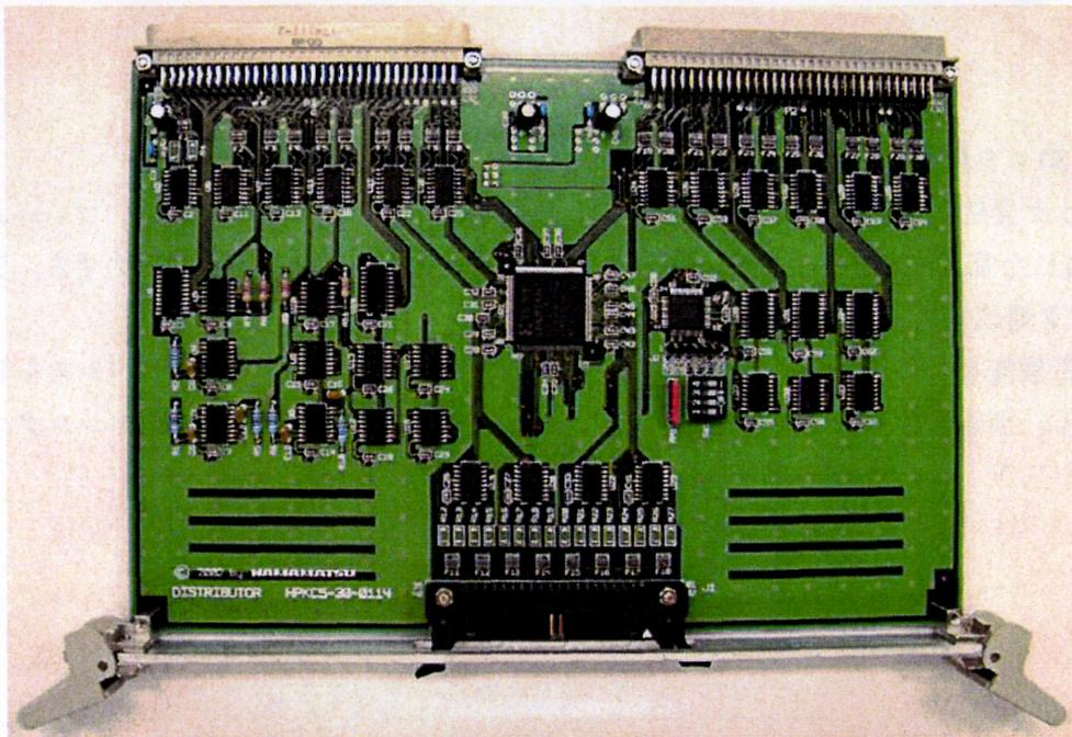
図 2. 振り分け回路部基板
