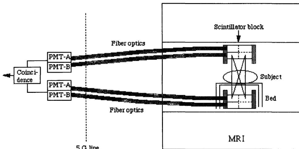
Fig. 5 MRI 中で測定可能な PET 装置全体の概念図
