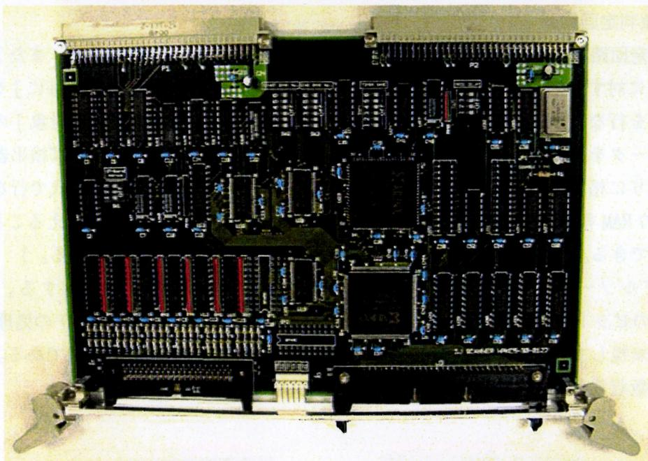
図6. アドレス変換回路部基板
