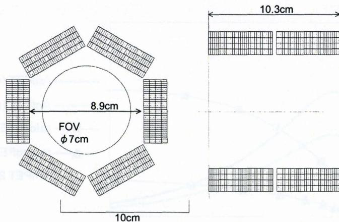
図4. 小動物用 PET 装置のデザイン例
