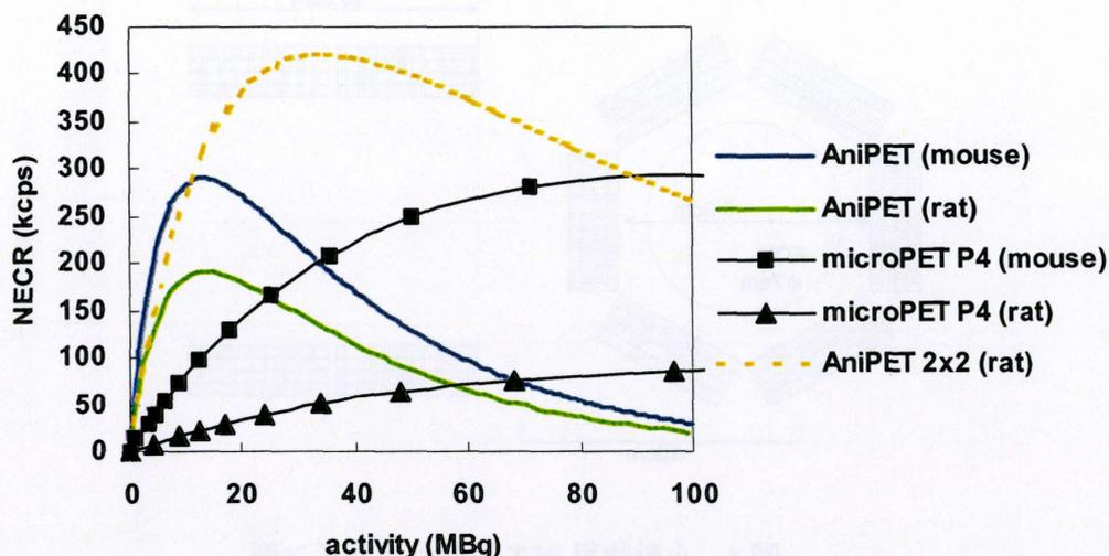
図 5. 小動物用 PET 装置の雑音等価計数率 (NECR) の比較
