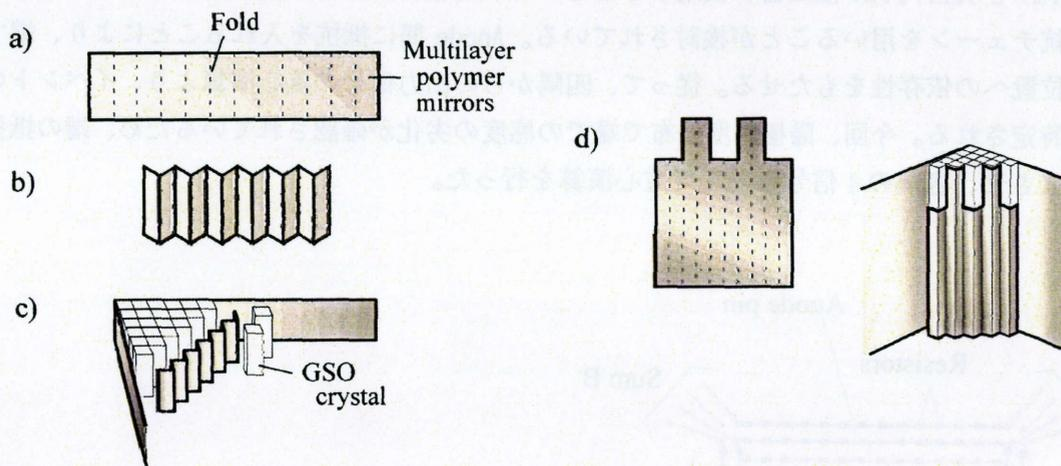
図4 検出器結晶の組み立て方。
