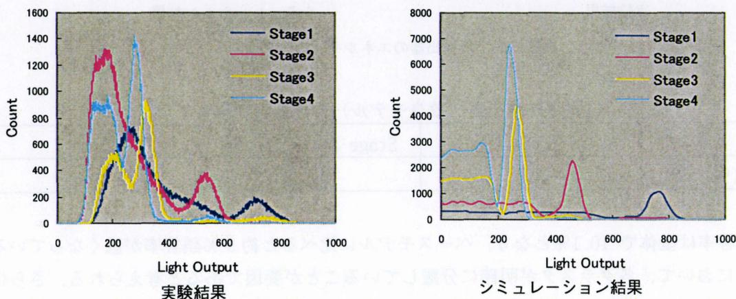
図3 4段 DOI 検出器 (ベースモデル) のエネルギースペクトル
