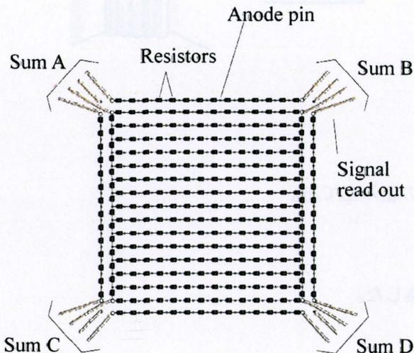
図 3 抵抗チェーン。256ch FP-PMT の出力口に取り付ける。
