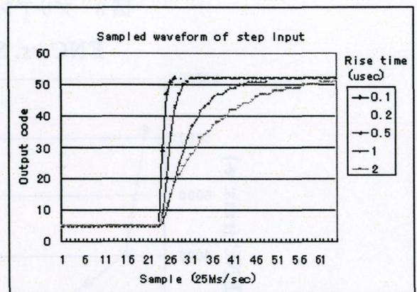
図 6 高速 AD 変換器の変換特性
