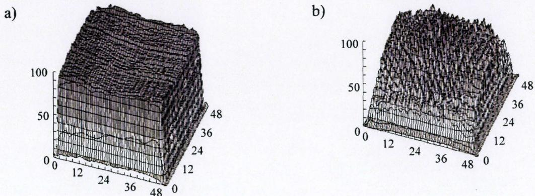
図 2 a) 256FP-PMT の陰極感度 b) 256FP-PMT 陽極感度
