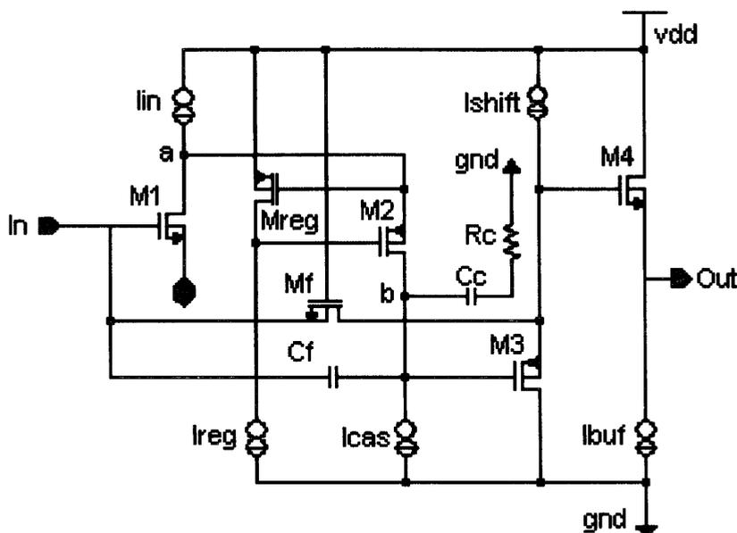
図 2 MOSFET による前置増幅器の例
