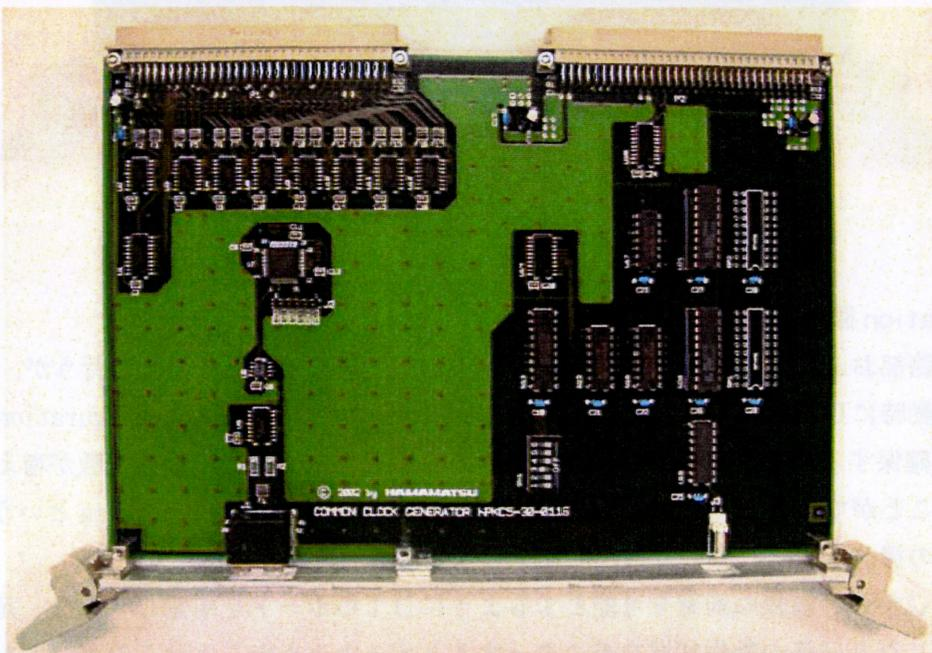
図4. 共通クロック発生回路部基板
