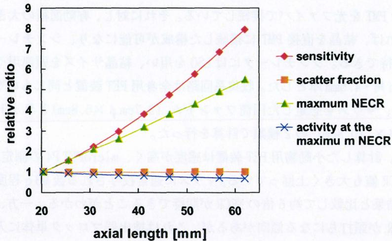
図3. 検出器長（リングブロック数）を変化させたときの性能の相対変化（検出器長 20.5cm を 1）
