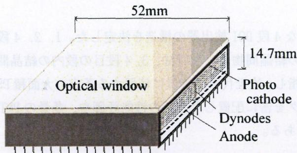
図 1 256ch FP-PMT の概観
