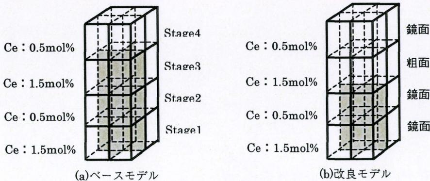
図1 4段DOI検出器の構造
