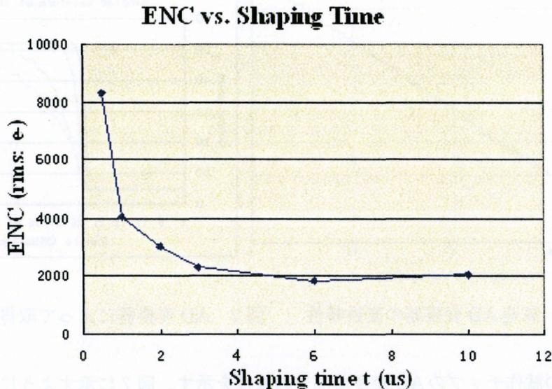
図 4 プリアンプの等価雑音電荷と波形整形時定数の関係
