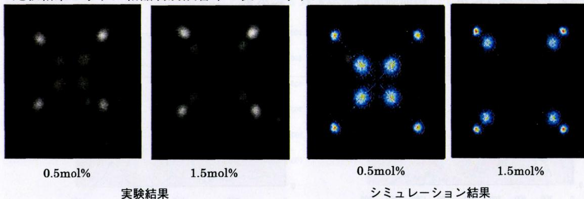
図2 4段 DOI 検出器ベースモデル (ベースモデル) の2次元マップ
