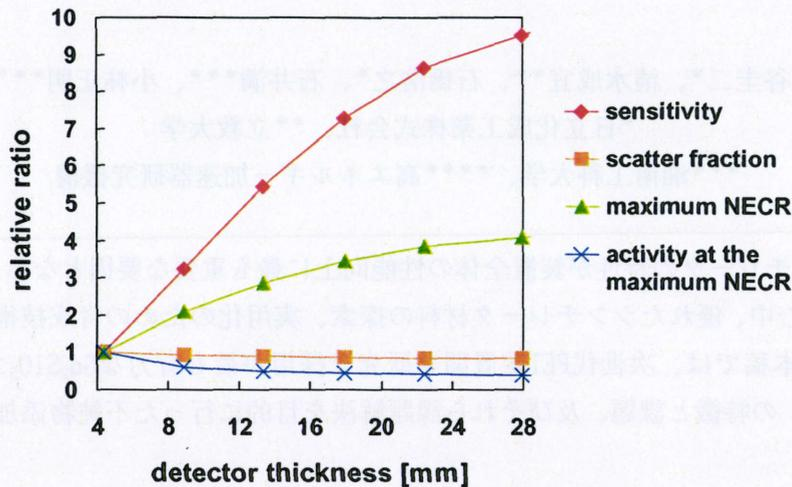
図6. トータル結晶厚 (DOI 段数) を変化させたときの性能の相対変化 (結晶厚 4.5mm のときを 1)
