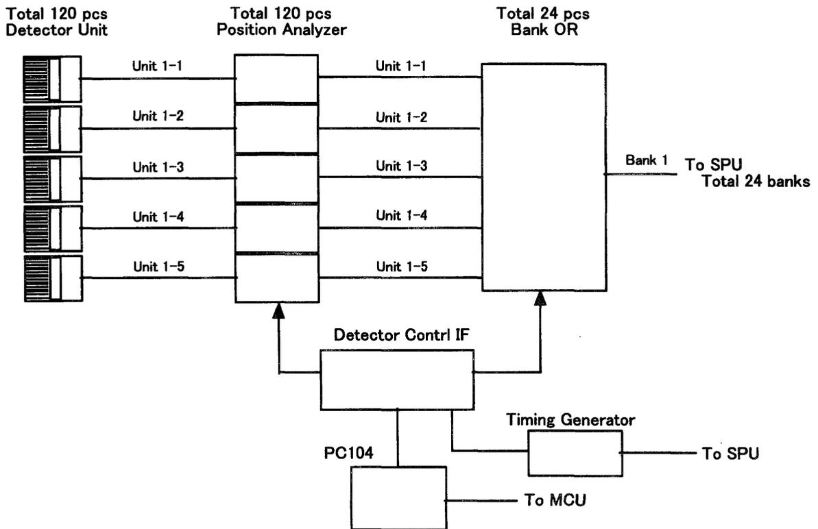
Fig. 1 次世代 PET 検出器信号処理回路全体構成図
