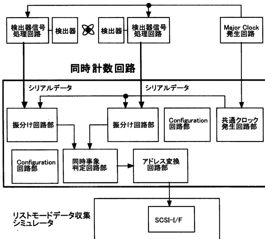
図1. 試作する同時計数回路のブロック図
