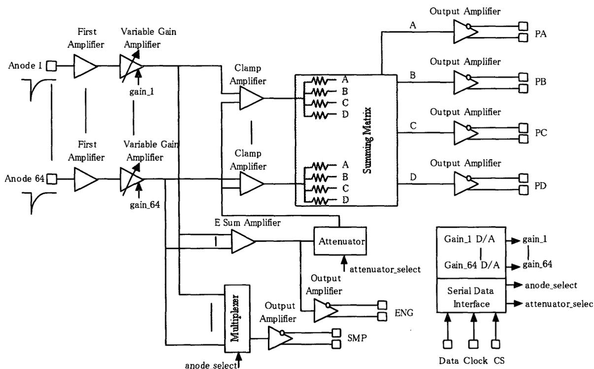
Fig. 3 Flat Panel PS-PMT 用フロントエンド ASIC 回路ブロック図
