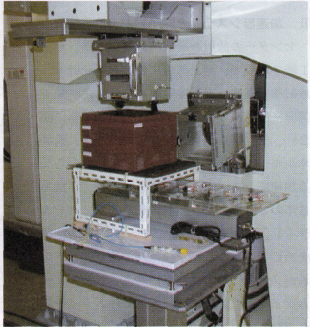
図5 陽子線の生物学的効果比の測定
