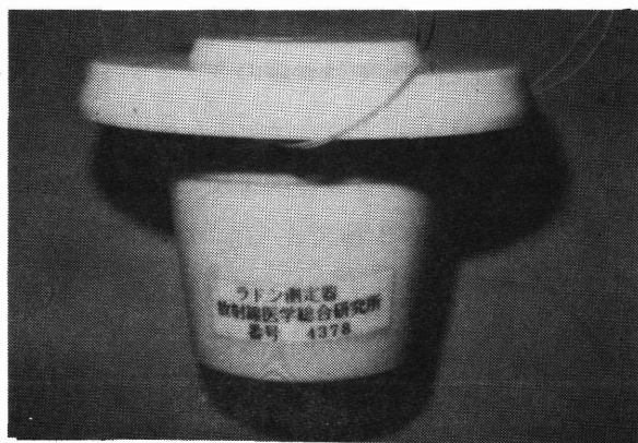
図2 カールスルエ型パッシブラドン測定器の外観と構造
