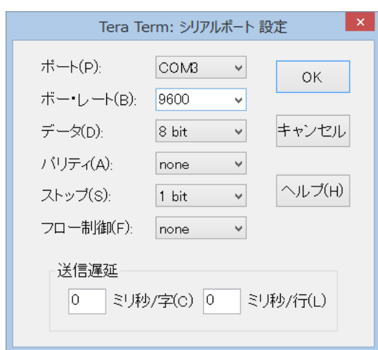
図 2. シリアルポートで設定すべきパラメータの例 (Tera Term [4]から)
