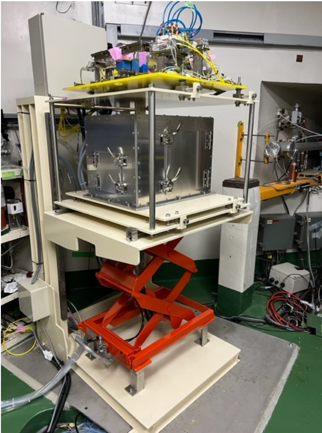
写真1. 上下2段式 C2 コース照射装置 (上段：固体ターゲット用、下段 Ra/Ac 専用照射装置)
