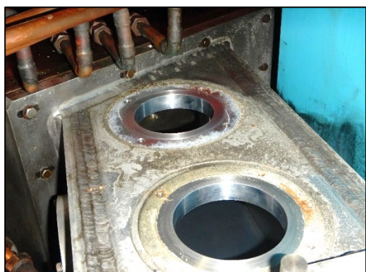
図 3. NIRS-930 本体側面のアルミチェンバー
