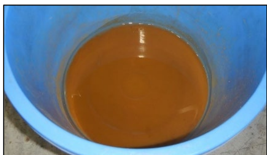
図 5. ホローコンダクター内部の溜水
