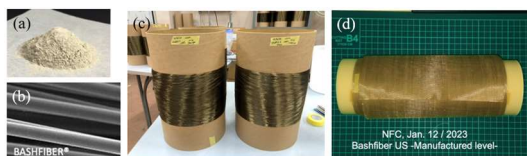
Fig.1. (a) fly ash, (b) SEM image of BASHFIBER ® , (c) BASHFIBER US ® , (d) BASHFIBER US ® fabric
