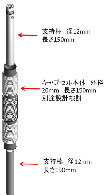
図4.4.3.16-2 円筒型キャプセル支持構造概念図
