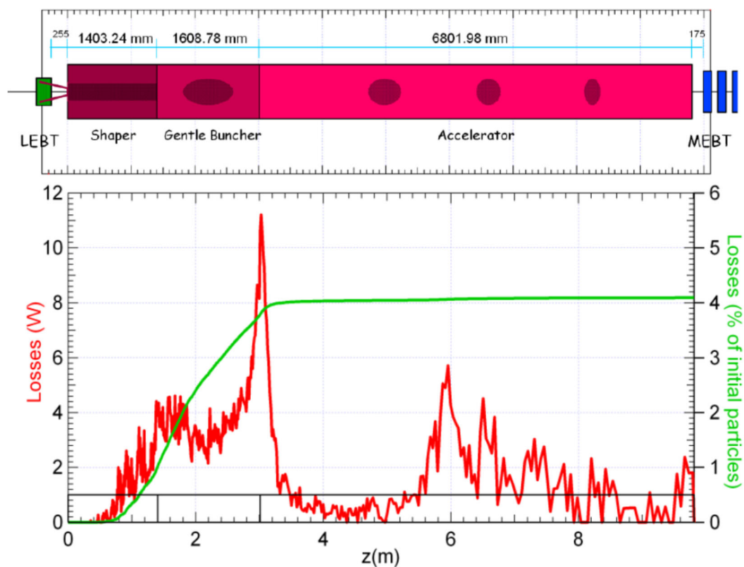
図4.2-11 粒子シミュレーションによるRFQ内のビーム損失分布 (設計変更前の入射器からのビーム入射条件での計算)
