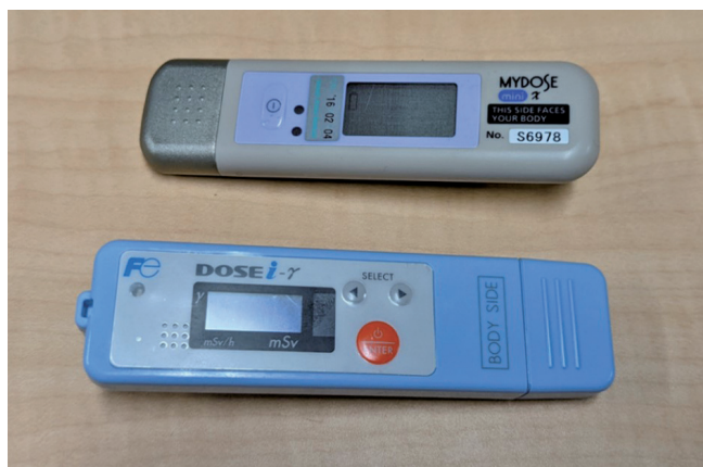
図1. 半導体式の個人線量計
